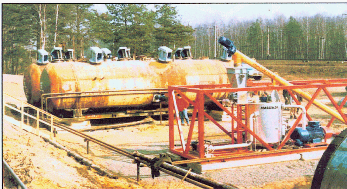
Рисунок 6. Фотография передвижного завода на салазках с непрерывным циклом
